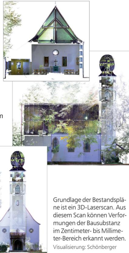
Grundlage der Bestandspläne ist ein 3D-Laserscan. Aus diesem Scan können Verformungen der Bausubstanz im Zentimeter- bis Millimeter-Bereich erkannt werden. Visualisierung: Schönberger
